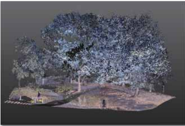
自動カラーリングされた3次元点群
