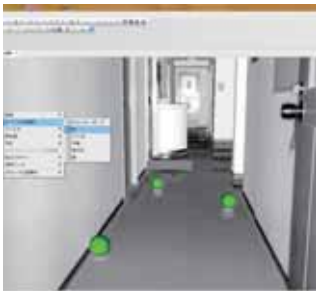
スフィアターゲットを良好な精度で認識した様子
