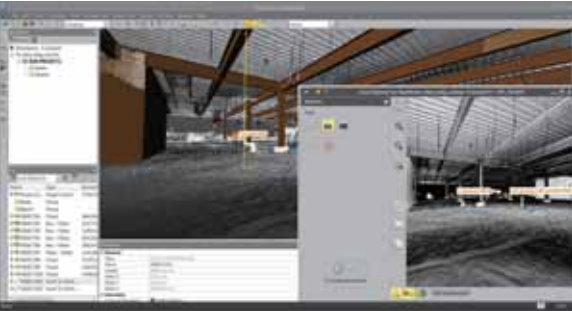
スキャンエクスプローラーを起動し、天井までの高さを計測している様子
